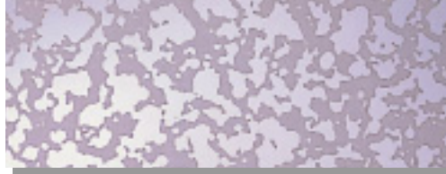
La profundidad del grabado se controla mediante el tiempo en que el acero inoxidable está expuesto al ácido.
