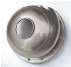
Ruostumattomasta teräslevystä syvävetämällä valmistettu pumpun kammio. Nesteen tuloaukko sijaitsee edessä ja sen poisto kammion yläpuolelta tapahtuu yläpuolisen, suurpainemuovatuspoistoaukon kautta.
