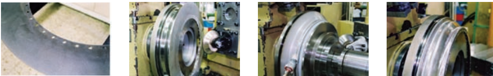
Vanteen ulkokehän painosorvausta. Ruostumaton teräs lujittuu muovauksessa ja siten sen iskunkestävyys paranee.
