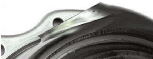
Suurpainemuovauksen avulla spiraalimaisuus kyettään integroimaan pumpun kammioon. Poistoaukon viimeistely on tehty huolella hyvän hyötysuhteen varmistamiseksi.
