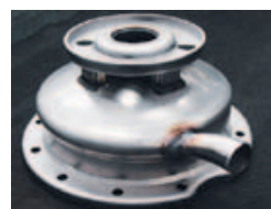
Etapy wytwarzania obudowy: głębokie tłoczenie, hydroformowanie, wiercenie i wyrównywanie powierzchni, montaż.
