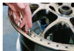
Montaż wieloramienno mocowania na wieńcu wewnętrznym poprzez wieniec zewnętrzny wykonany ze stali nierdzewnej.
