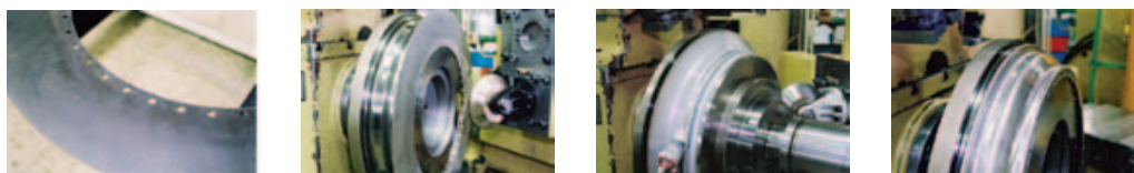
Wyoblanie zewnętrznego wieńca ze stali nierdzewnej. Podczas formowania wytrzymałość stali nierdzewnej wzrasta, czego wynikiem jest podwyższona zdolność do amortyzowania wstrząsów.
