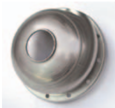
Obudowa pompy wykonana z głęboko tłoczonej stali nierdzewnej. Otwór wlotowy znajduje się na przedzie, a płyn opuszcza obudowę przez hydroformowaną kryzę u góry.
