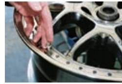
Yıldız tekerlek göbeğinin paslanmaz dış jant üzerinden iç janta montajı.
