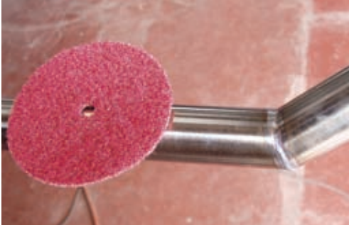
Oplissing met één lasnaad, in verstek
