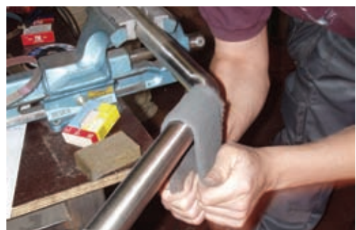
Homogeen nabewerken van de complete leuning. De overgang tussen de twee delen is “zacht”, zonder “hoek”.
