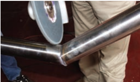
Behandeling van de binnenhoek met aangepaste schijf
