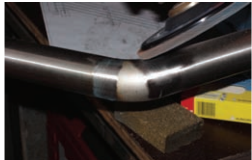
Behandeling van de gehele omtrek met lamellenschijf
