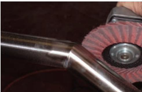
Behandeling van de buitenhoek met een lamellenschijf
