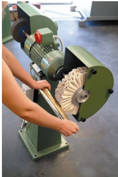
Polijsten gebeurt met behulp van katoen of vilt en eventueel pasta. Op de foto is het afwerken van buisoppervlakken te zien met geventileerde schijven op een stationaire machine.
