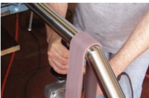
Machinaal nabewerken om een homogeen uiterlijk te verkrijgen. De "hoek" blijft zichtbaar.
