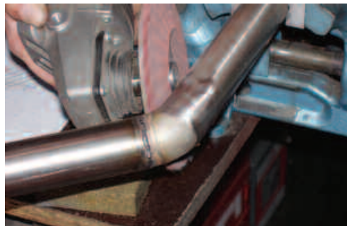
Kąt tworzony za pomocą złącza kolankowego
