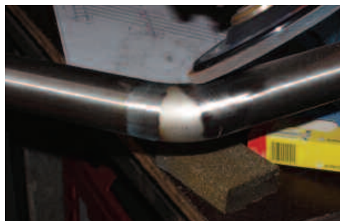
Kompletny obwód połączenia może być obrobiony tylko za pomocą ściernicy fibrowej
