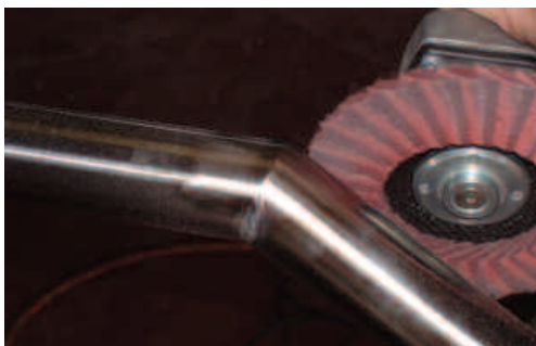
Obróbka kątów zewnętrznych przy użyciu ściernic fibrowych
