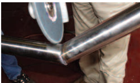
Obróbka wewnętrznego kąta z zastosowaniem narzędzi do wykończenia kątów wewnętrznych
