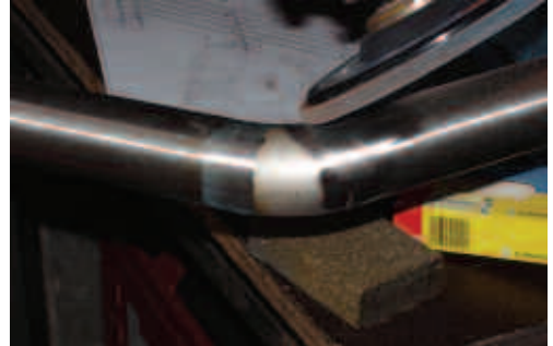
Bağlantı dirseği dış bölümünün flap disk ile sonlanması
