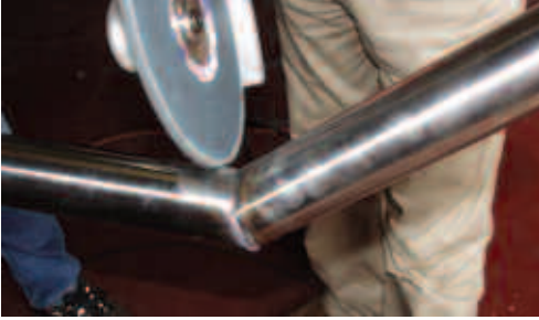
Dirsek iç bölümündeki kaynak dikişinin flap disk ile sonlanması
