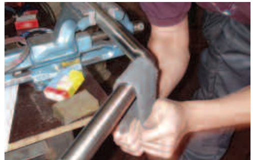
Bağlantı parçalarının birbirlerine tam uyumlu ve düzgün bir şekilde sonlanması, borunun dikişsiz gibi görünümünü sağlar
