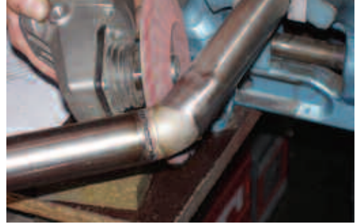
Dirsek kullanarak kaynakla oluşturulmuş geniş açılı boru
