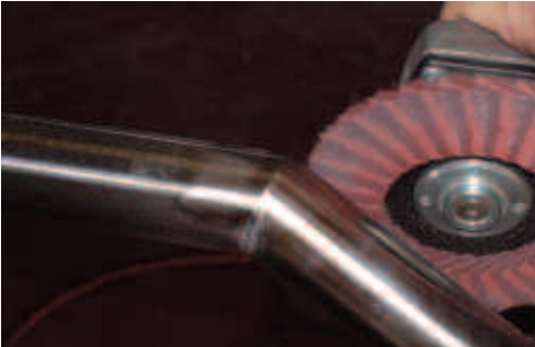
Dirsek dış bölümündeki kaynak dikişinin flap disk ile sonlanması
