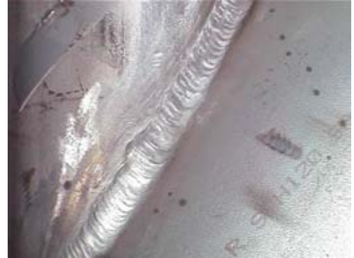
Detail van de gelaste zone na oppervlakte-behandeling : het doel van deze behandeling is niet om de lasnaad te verwijderen maar wel de eraan gekoppelde aanloopkleuren.
