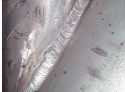
Szczegół obszaru spawania po chemicznej obróbce powierzchni – celem tej obróbki nie jest usunięcie samej spoiny ale towarzyszącego jej przebarwienia.
