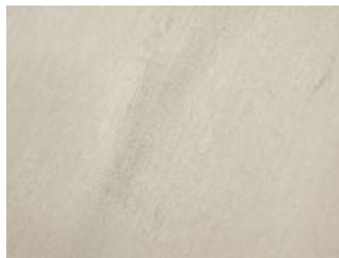
Na produktach wyżarzonych po usunięciu zgorzeliny i wytrawieniu pozostaje matowy szary nalot. Mechaniczne usuwanie zgorzeliny nadaje powierzchni szorstkość.
