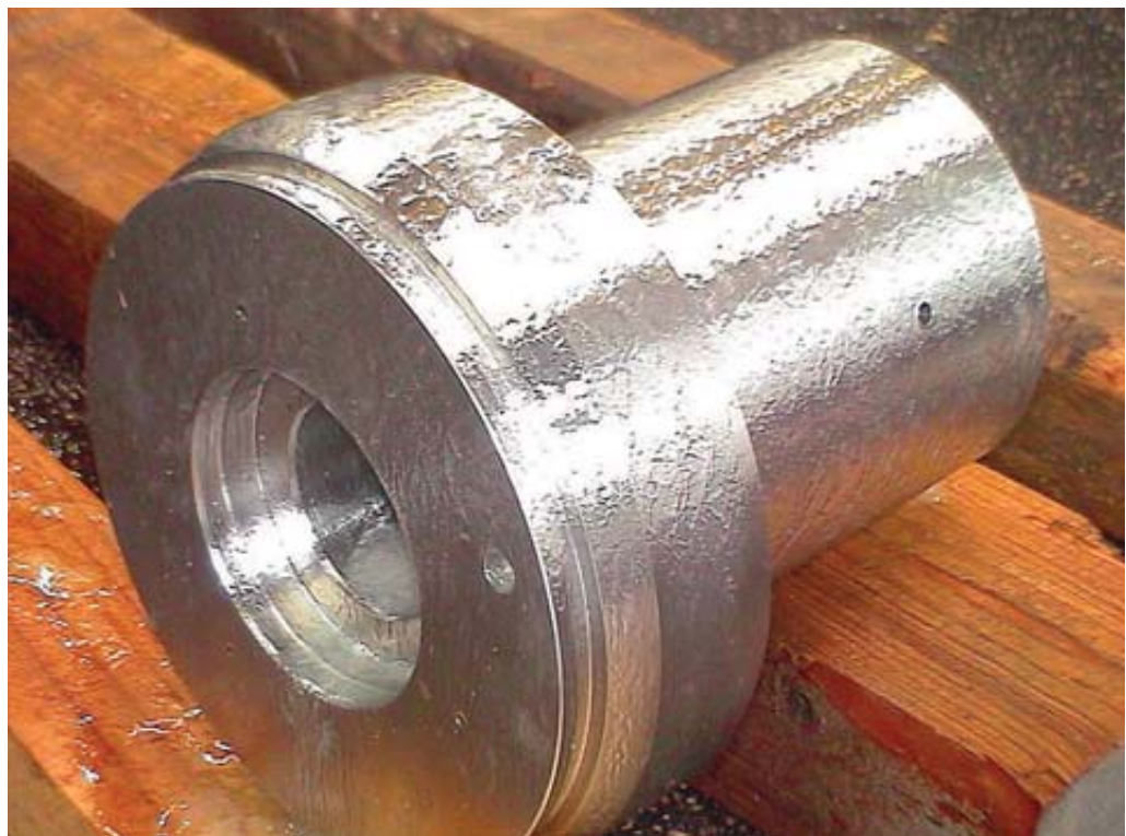
Niewielkie części ze stali nierdzewnej mogą być skutecznie wytrawiane za pomocą żelu nakładanego pędzlem.
