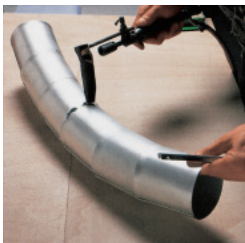
Demonstration av lödning av en sammansatt rörböj och en rännvinkel.
