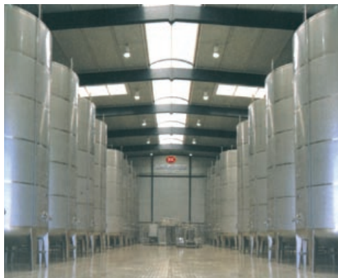
Korozi-vzdorné oceli mají lesklý a atraktivní povrch – a především se snadno čistí a udržují. Fotografie: Cedinox
