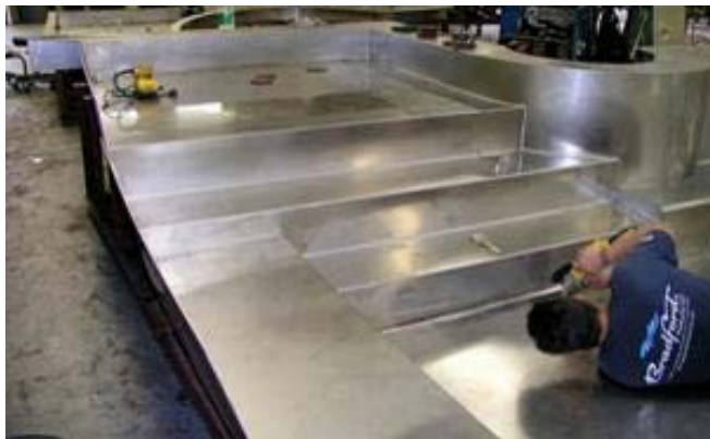
简洁便利的焊接和抛光使其容易进行现场组装。 照片：美国弗吉尼亚，亚历山大港，APSP
