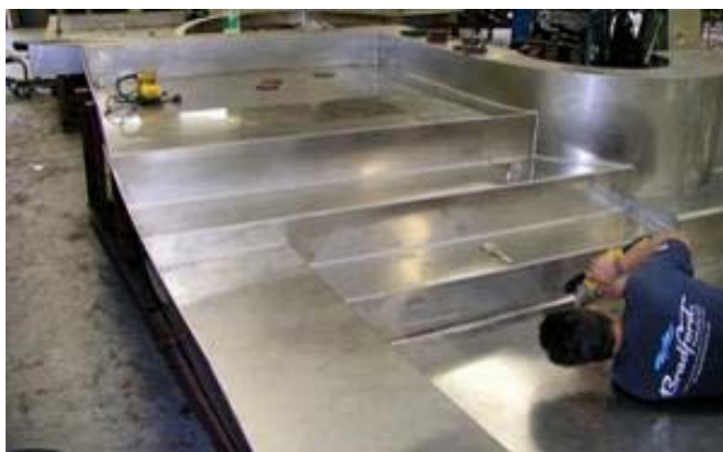
A facilidade de serem soldadas e polidas é um benefício quando as piscinas tem que ser montadas no local.
