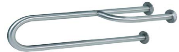
Tubos de aço inoxidável podem ser facilmente dobrados na forma desejada e os pontos de soldas podem ser polidos até se tornarem indistinguíveis da superfície original. Foto: Mediclinics, Barcelona, Espanha
