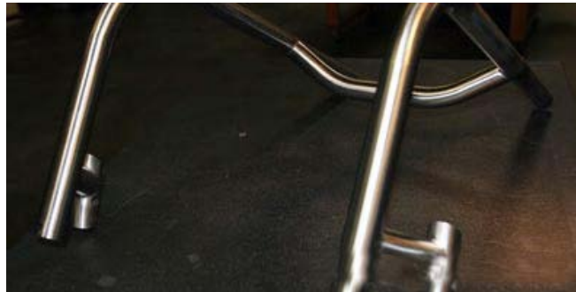
Aços inoxidáveis de alta resistência tais como os austeníticos endurecidos ou os duplex, podem ser utilizados com menor espessura e, conseqüentemente, reduzir o peso dos componentes estruturais das cadeiras de rodas. Foto: KVA Stainless, Escondido, CA, EUA
