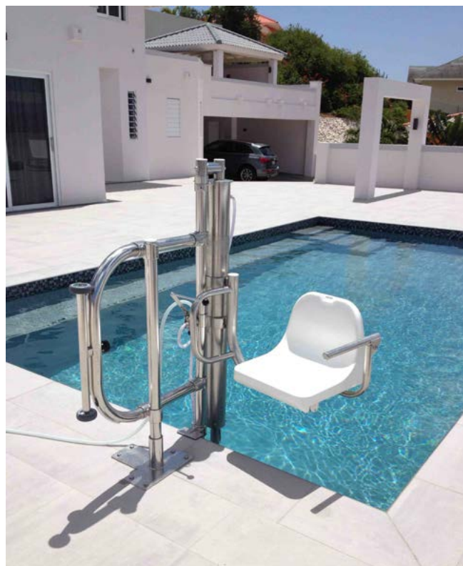
Utilizando a pressão da água corrente (min 3.8 bar), os elevadores de piscina podem ser independentes de energia elétrica. Foto: Lehner Lifttechnik, Neukirchen am Walde, Áustria
