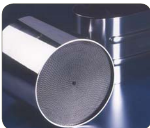
SUS430J1L 不锈钢， 催化式排气净化器外壳， 蜂窝结构，20%Cr-5%Al
