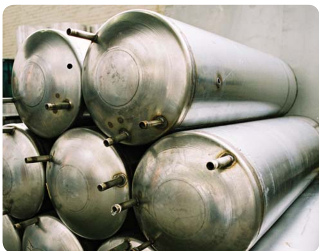
冲压的罐炉顶部，441 不锈钢，南非。
