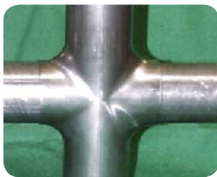
1.4003 被压成形的焊管。
