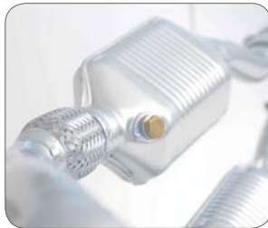
排气净化器外壳，1.4509/441 不锈钢， Faurecia
