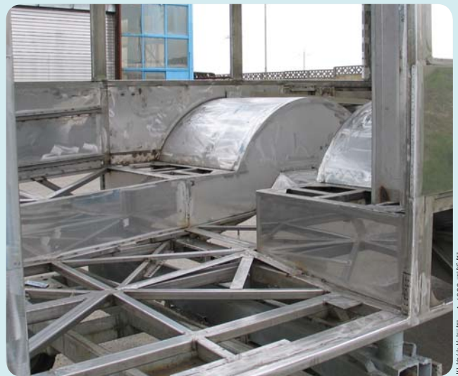
焊接结构框架，1.4003 不锈钢。
