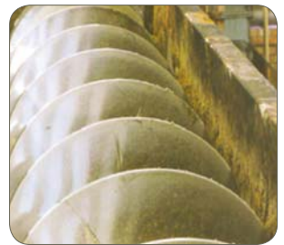
1.4003/410 不锈钢, Columbus, 南非。在这里, 铁素体不锈钢使用寿命已达 18 年。
