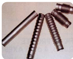
430Ti 焊管的弯曲。
