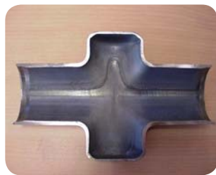
1.4003 被压成形的焊管。
