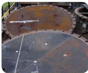
1.4003/410 不锈钢, Columbus, 南非。碳钢罩 (上) 与使用了 6 年的铁素体不锈钢罩比较。
