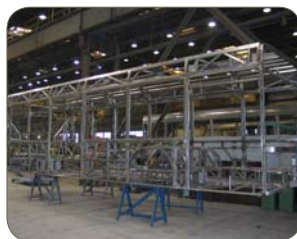
1.4003 不锈钢焊管及面板, Solaris Bus & Coach Co, 波兰
