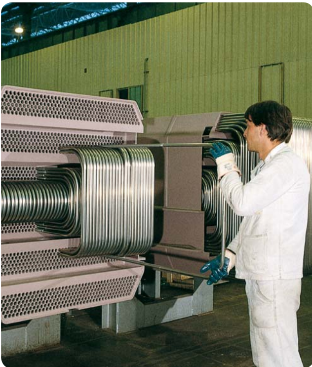
수분분리 제히터 (Moisture separator reheater) (439, 유럽)
