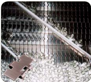
컨베이어벨트 (CONVEYOR BELT)
