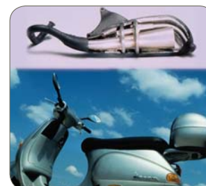
Tipo 1.4509/441, Centro Inox, Itália. A nova Vespa ET2 é equipada com um silenciador catalisador ferrítico
