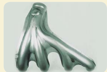
Coletor de escape estampado em aço inoxidável 441.
