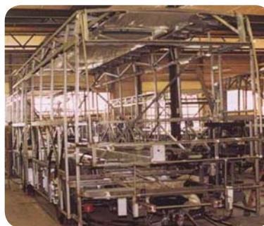
Estrutura da carrocina de um ônibus em aço inoxidável 430, África do Sul
