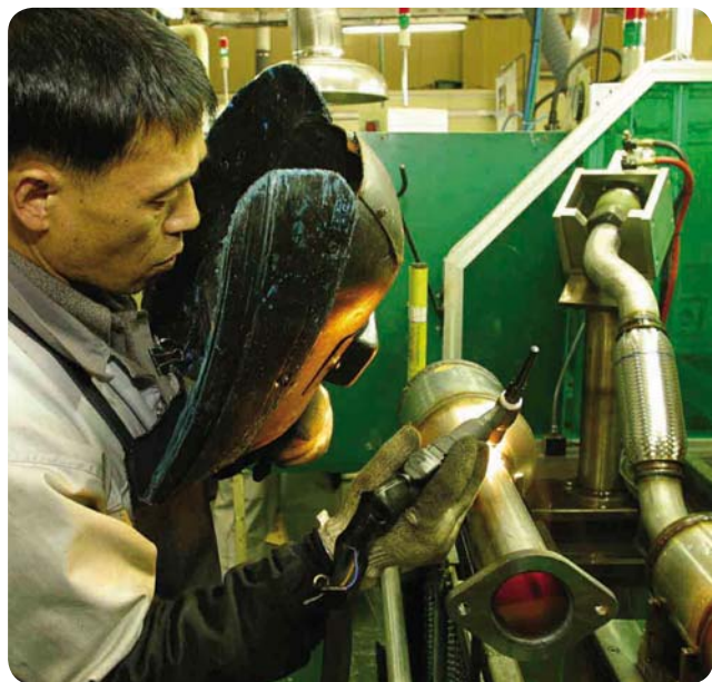
Soldagem sistema de escapamento, tipo 439, Korea.
