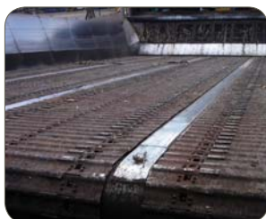
Tipo 1.4003/410, Columbus, África do Sul. Esta máquina está em funcionamento há 22 anos
