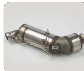
Tipo 304 & 441, filtro de partículas de diesel, Mercedes Classe E, Faurecia
