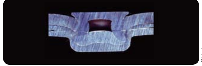
430 üzerinde otomatik perçinleme, 1,5 mm.
