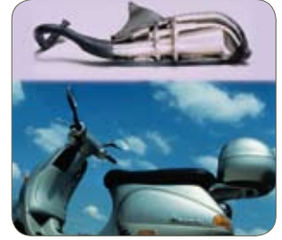
1.4509/441 kalite, Centro Inox, İtalya. Yeni Vespa ET2, bir ferritik katalitik susturucuya sahiptir.
