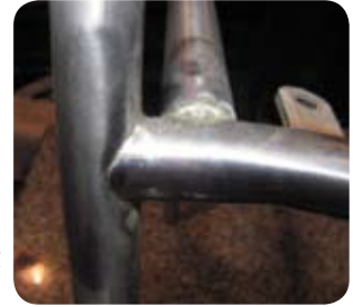
Sert lehimle kaynaklanmış bonalar, 441 kalite.
