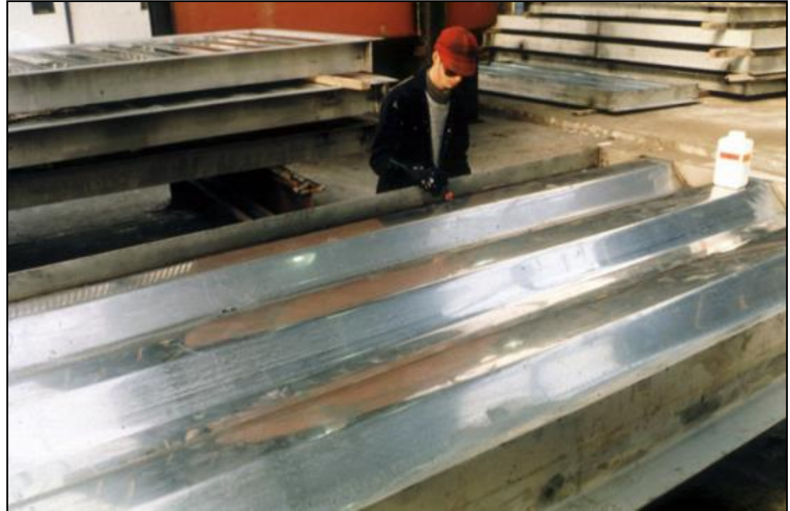
Panneaux trapézoïdaux résistant aux explosions. Ils sont destinés à des superstructures de plates- formes offshore
