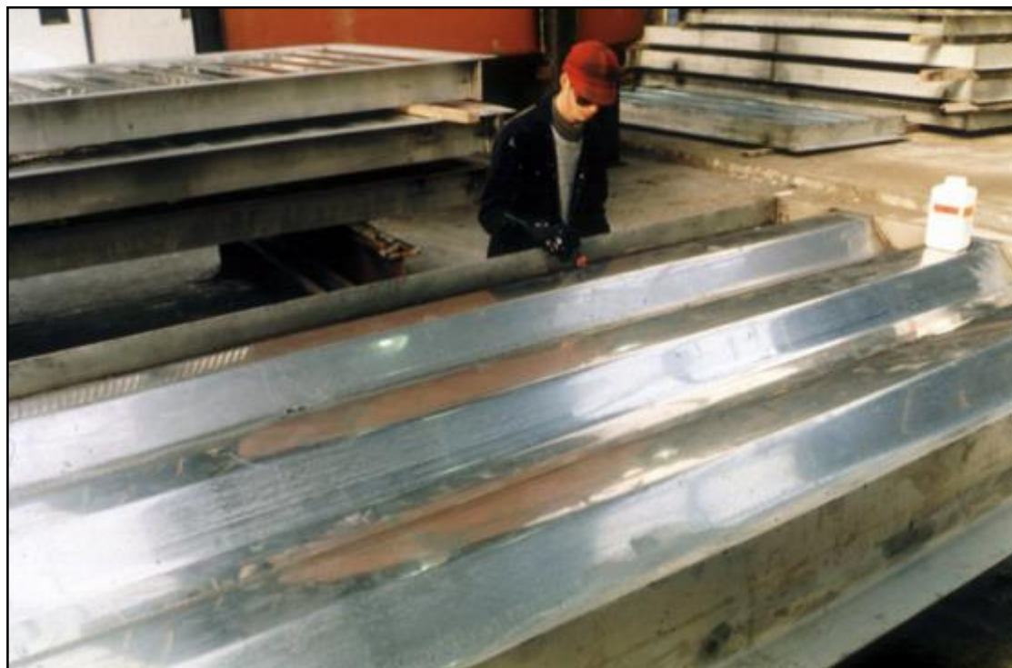
Odporne na wybuch ściany o przekroju trapezowym są stosowane do nadwodnych części konstrukcji platform wiertniczych
