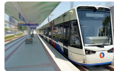
使用双相不锈钢框架的有轨电车车厢 供图: 斯泰德勒公司
