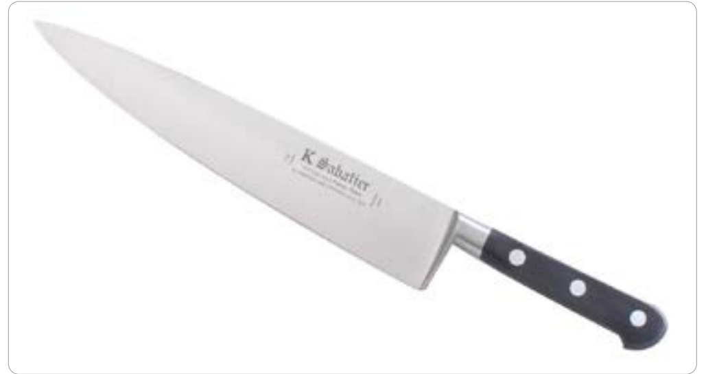
专业切割刀，使用0.5%碳和13%铬马氏体不锈钢制成，经过锻造和热处理后，硬度达到55HRC。供图：Sabatier-K。
