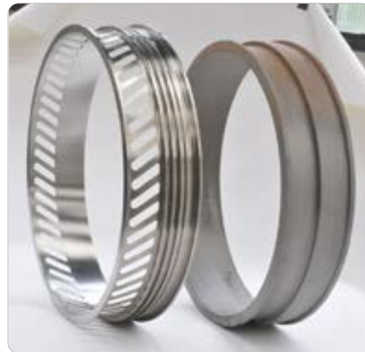
反应器环，经过压延和焊接后，再按照紧公差进行切削加工，用于空客A320-330、波音737、747、777、787
