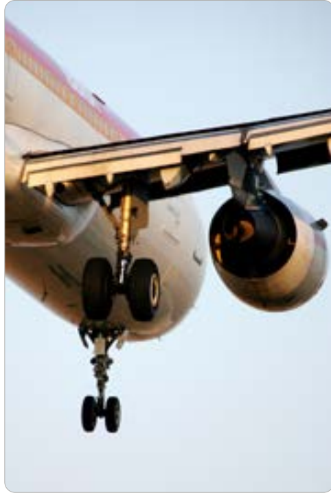
起落架组件：等级钢材： EN:1.4548 (AISI 630) 重熔钢；以及 EN:1.4545 (AMS 5659、ASTM 564)。 供图：Iconos。
