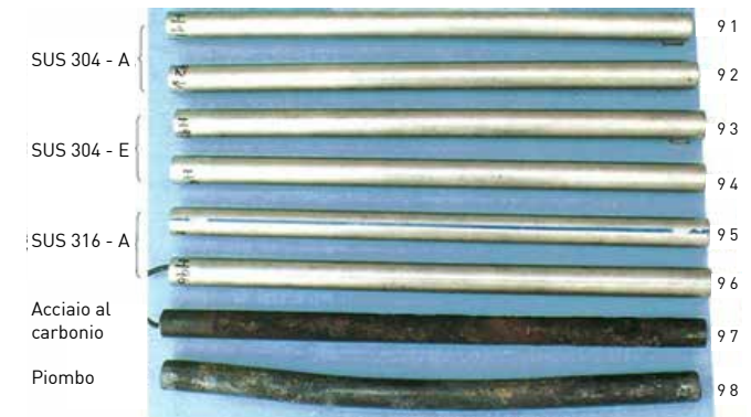
1. Città di Kushiro, Test N. H; dopo decapaggio acido
