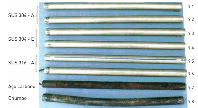
1. Cidade de Kushiro, teste No. H; após decapagem com ácido
