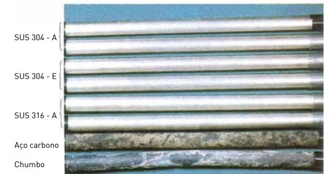
2. Cidade de Kuwana, teste No. P; após decapagem com ácido
